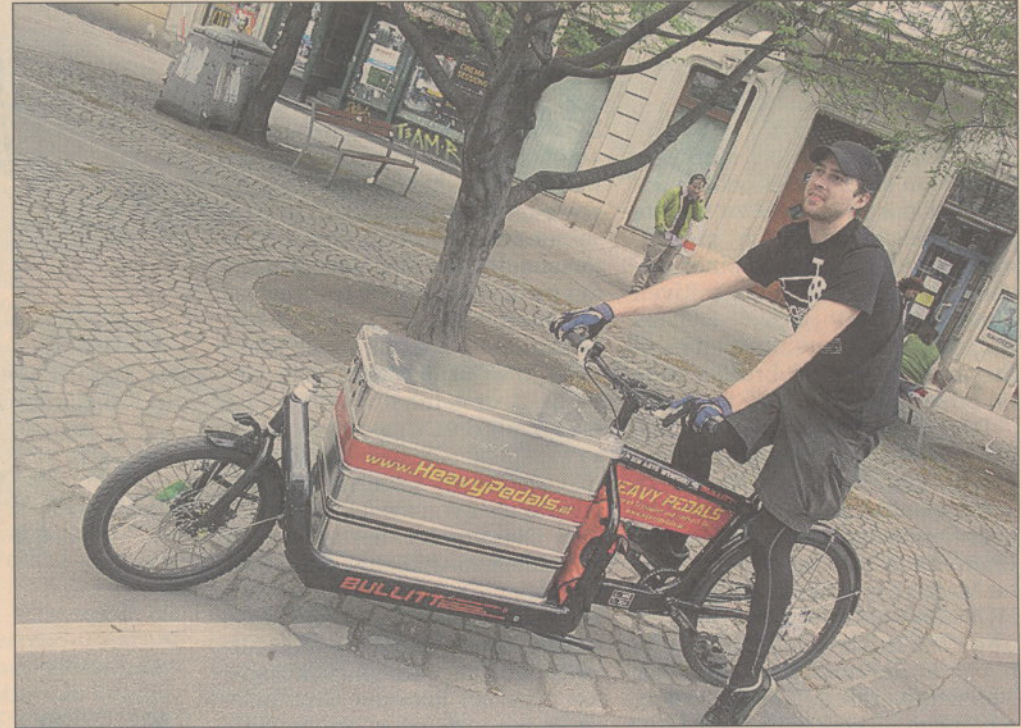
Die „Heavy Pedals“ im Einsatz mit schwerem Gerät. „MCS Truck“ (li.) und „Bullit“ heißen die Velos. Beide können mit bis zu 100 Kilogramm beladen werden. Foto: Maria Sterkl
